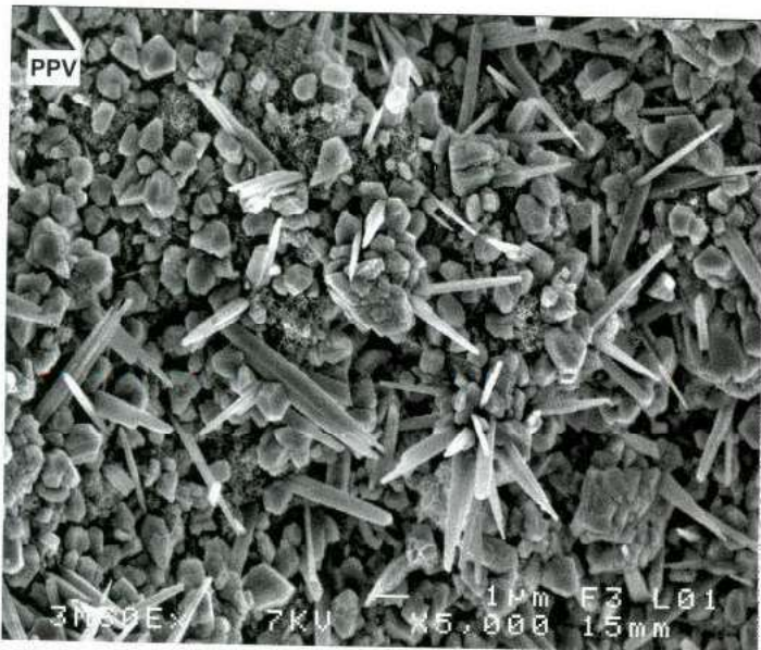
Figure 4 : Observation au MEB de la surface externe des pâtes après trois mois de conservation dans l'eau de mer.
